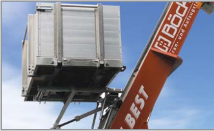
Stufenlose, gasfederunterstützte Verstellspindel 17–87 Grad (optional)
