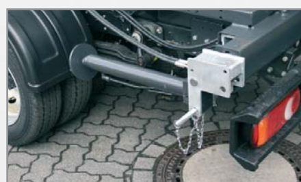
Hydraulische Abstützungen, 90° abklappbar (Fahrstellung)
