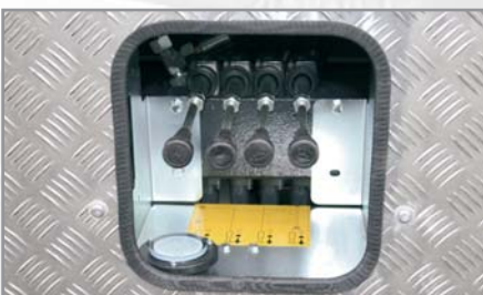
Steuerstand für die hydraulischen Abstützungen
