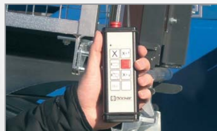
Elektr. Steuerung mit Funkhandsender für Bedienung von oben
