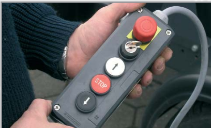
Elektrische Steuerung per Kabelbedienung
