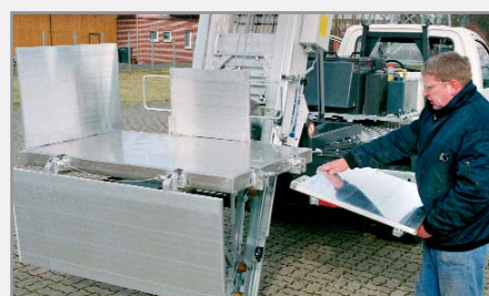
Seitenwände abklappbar 90°/180° und komplett abnehmbar
