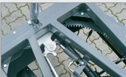
Stufenlose, hydraulisch lösbare Drehkranzsperr
