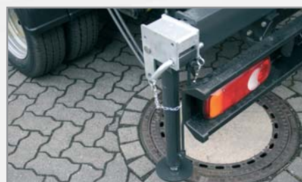
Hydraulische Abstützung in zwei Rohren
