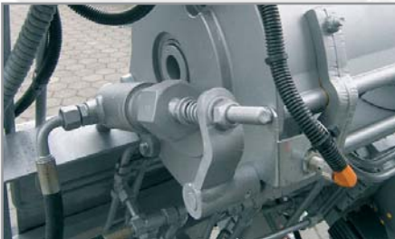
Automatische, hydraulische Klinkensperre (optional)
