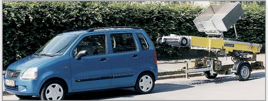
Der Junior-Bauaufzug ist mit allen gängigen Pkws transportierbar.
