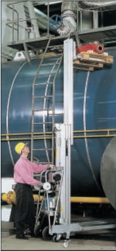
Modell LH med elektrohydrauliskt lastspel. Lyftkapacitet 300 kg. Lyfthöjd t.o.m. 7,50 meter.
