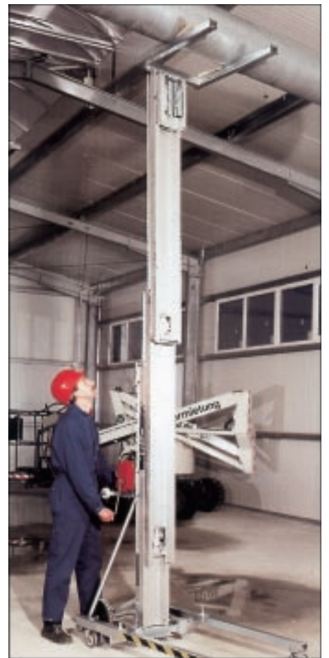
Modell LMC med lastvinsch. Lyftkapacitet 250 kg. Lyfthöjd t.o.m. 6,29 meter.
