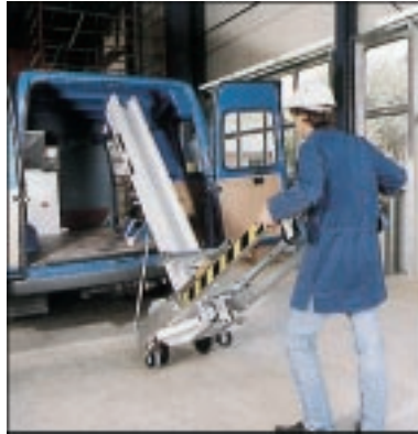
En person kan lasta eller lossa montageliften på bil eller släp.
